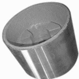
Шкивы тормозные являются необходимой деталью в работе грузоподъемных механизмов и функционируют в паре с колодочными тормозами (например, крановые тормозные шкивы). В большинстве случаев шкив тормозной располагается между валом электродвигателя и входным валом редуктора, и в некоторых случаях его устанавливают с обратной стороны входного вала редуктора.
