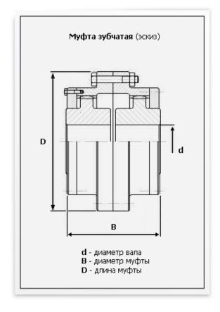
Для применения зубчатых муфт общего машиностроительного применения, которые изготавливаются с целью соединения угловых валов с соосными, существуют государственные стандарты, предусмотренные ГОСТом 5006-94 и ГОСТом Р 50895-96. Такой стандарт применяется только для муфт, что используются для компенсации осевых и радиальных смещений при передаче вращения в рамках 1000-63000 Н\*м.
