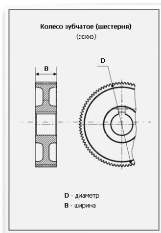
Зубчатая передача состоит из колеса и шестерни. Они являются единым механизмом, при этом шестерня (меньшее по размеру колесо) является ведущим, а колесо побольше – ведомым.
