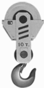
Крюковая подвеска является неотъемлемой частью грузозахватной конструкции крана. Крюковая подвеска мостового крана служит для соединения кранового (грузового) крюка непосредственно с подъемным канатом. Её конструкцию нужно выбирать с учетом относительного расположения, числа блоков и количества ветвей каната, а также учитывать конфигурацию кранового крюка и другие факторы.
