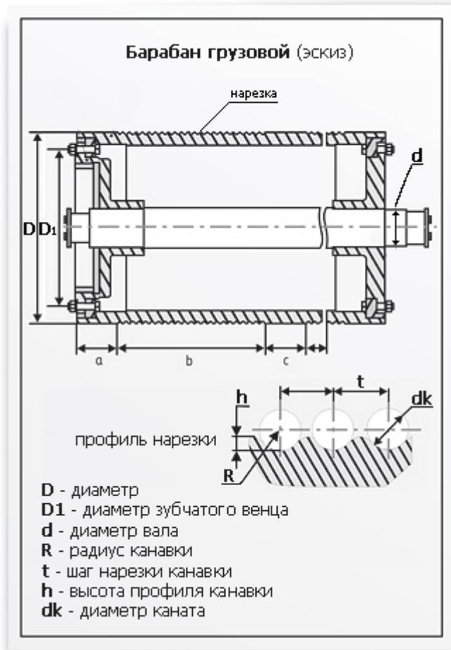
Изготовление барабанов происходит следующим образом. К литой или сварной трубе при помощи сварки присоединяются фланцы, на которые крепятся ступицы с помощью болтов. На последние прессуется вал. Барабан крановый соединяется с редуктором при помощи зубчатой ступицы или венца, которые монтируются на одном и том же днище.
